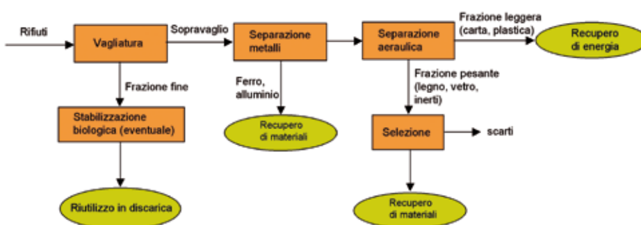
Figura 1 - Esempio di schema di processo per un trattamento di landfill mining negli Stati Uniti (modificato da Diaz e Savage, 2000)
